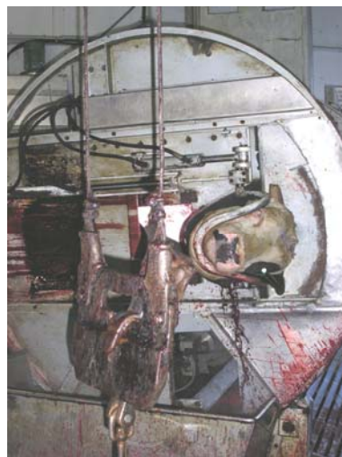
Figur 7. Djuret roteras tillbaka uppåt efter snittläggning. Samtidigt lossas huvudhållarbygeln.
