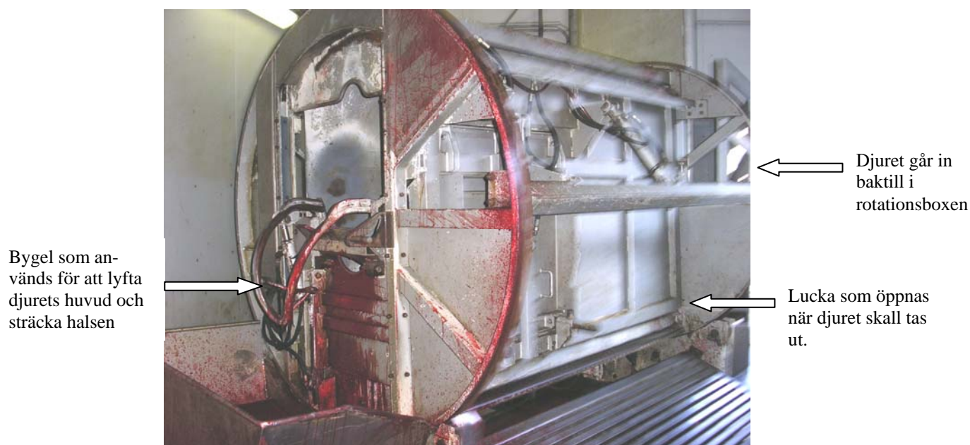
Figur 1. Översiktsbild över rotationsbox av typen "Weinberg pen"
